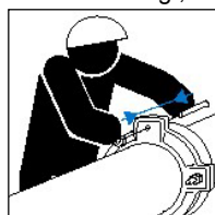
Colocación de los pernos
